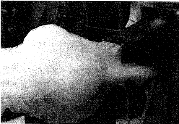
写真2 通風口網よりの発泡状況
