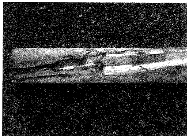
写真4 シロアリによる食痕を受けた検出子
