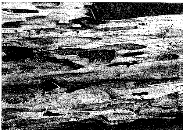
図2 ダイコクシロアリのスギ柱食痕(母島北港)
