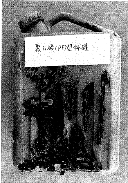
写真7 イエシロアリによるPE容器への加害
