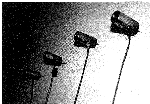
写真2 針状のウェーブガイドを用いて内装壁に取り付けたAEセンサ。センサは円筒状の鞘に収まっており、針先端が木部内部を伝わるAE波を検出し、鞘を介してセンサに伝わる。
