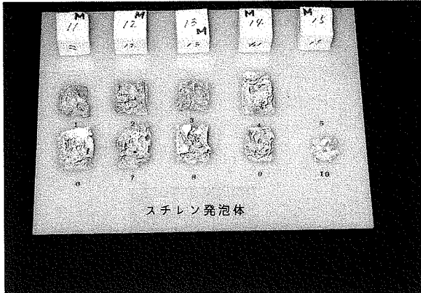
写真7 断熱材のシロアリ選択試験
