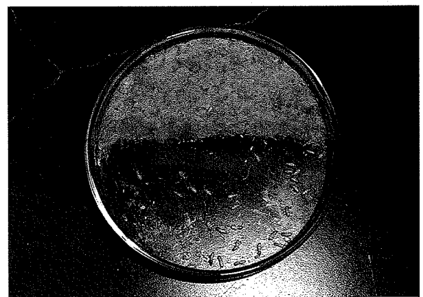
図3 小ブロックと木粉でのシロアリ試験 a:小ブロック試験, b:木粉試験
