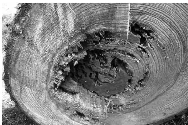
写真11 10mmのビットで穿孔し、被害を見つけた。
