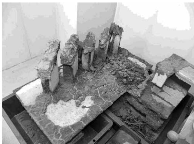
写真19 セメント板上に構築された蟻道
