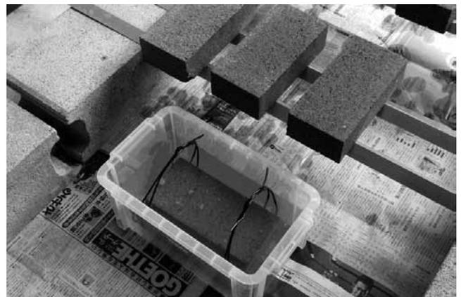
写真16 ホウ酸製剤B浸漬処理
