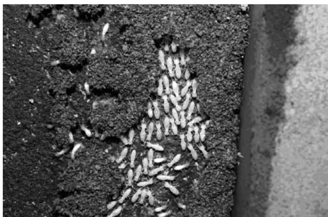
写真34 36時間後炭ホウ酸Aレンガの幅広蟻道
