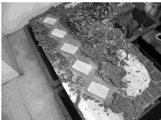
写真20 蟻道の除去状況（試験体設置直前）
