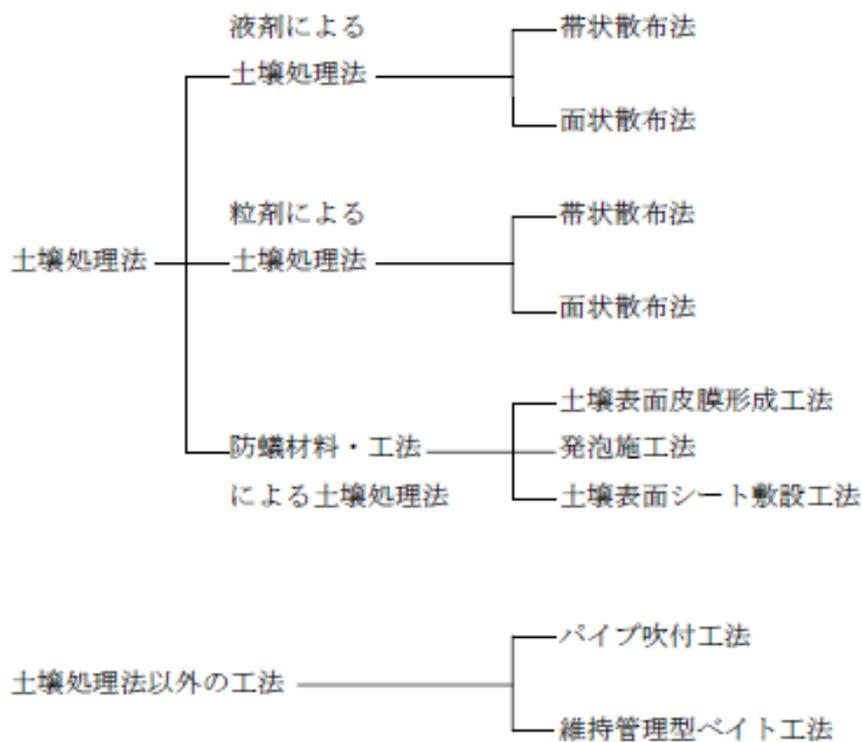
図 1 土壌処理等の工法による分類
