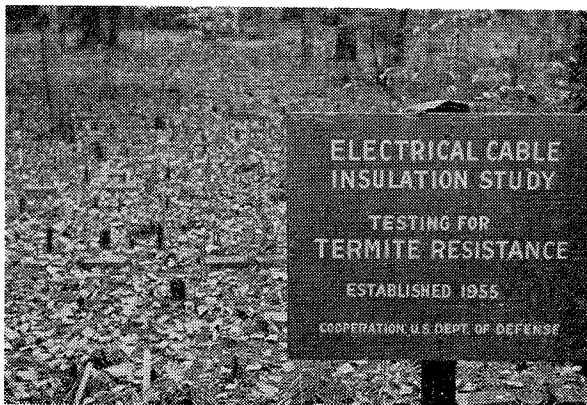
写真—2 Gulfport の実験所：ケーブル試験区、各種のケーブルを使用し、ケーブルの両側に木片を添えてあるのが見える。
