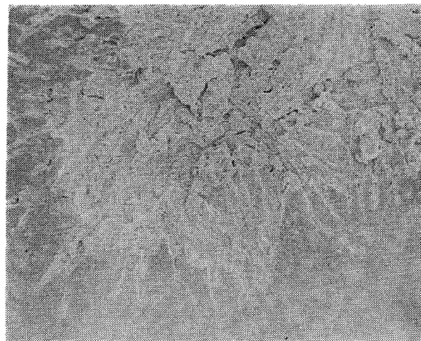
写真21 かなり軟質のPVC板におけるイエシロアリの食痕(×100)
