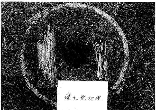
写真-3 壤土無処理区におけるポリバケツ内の松材
