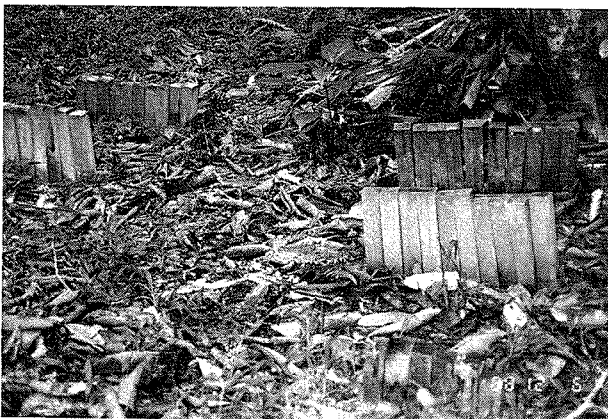
写真11 FRIM 構内の野外杭試験
