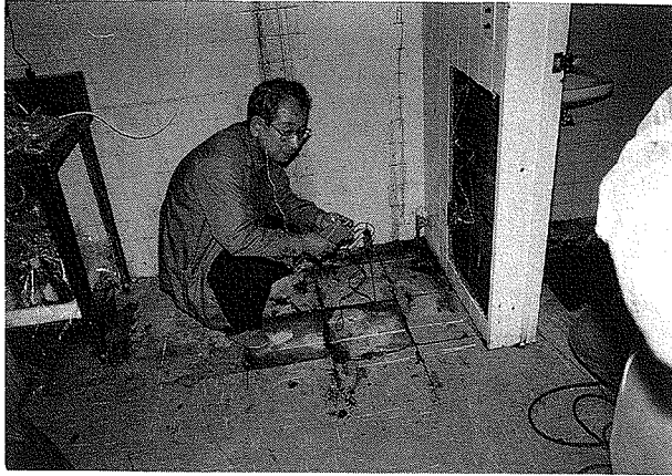
写真6 厨房のコンクリートたたき下に Sonic Detector を挿入してシロアリ巣を探知しているところ（この下にイエシロアリの巣があることが確認された。）
