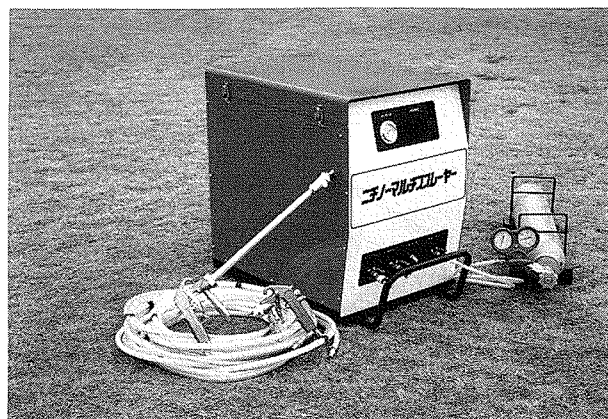
写真-1 クリーンマルチ施工用装置
