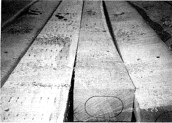
写真9 防腐工場の前加工済みのまくら木、イヌクギ穴、インサイジング、割れ止め等、防腐処理前の加工がすべて完了した南方産材のまくら木。
