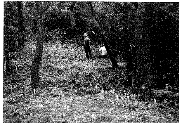
写真8 下草を刈ってシロアリ調査用の松杭が打ち込まれた第1試験地
