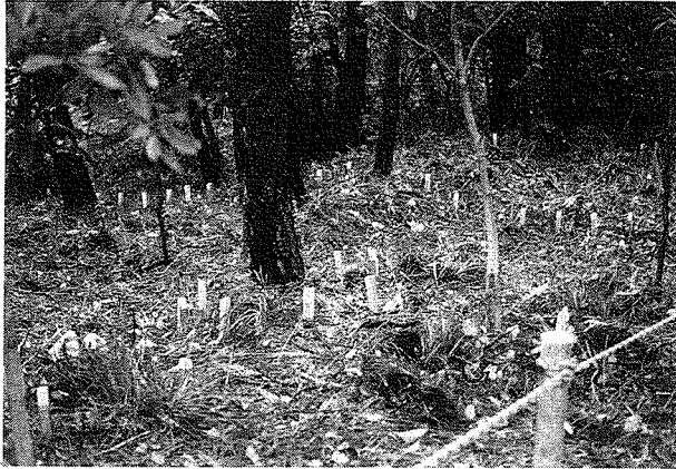
写真6 シロアリの生息状況を調べるために松杭が打ち込まれた第2試験地
