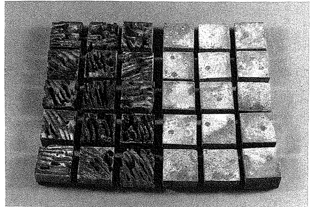
図17 シロアリ食害試験後の亜鉛溶射試験体（右）と無処理木材（左）
