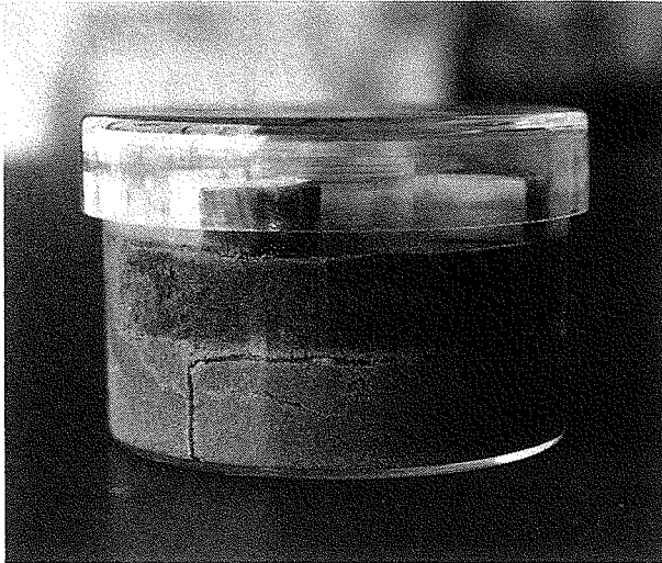
図18 水ガラス処理層のシロアリ室内実験装置 (下方から侵入したシロアリは水ガラス処理層を貫通できず、上方のマツ材まで到達していない。)
