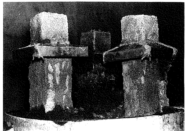
図15 実験中の防蟻板試験体
