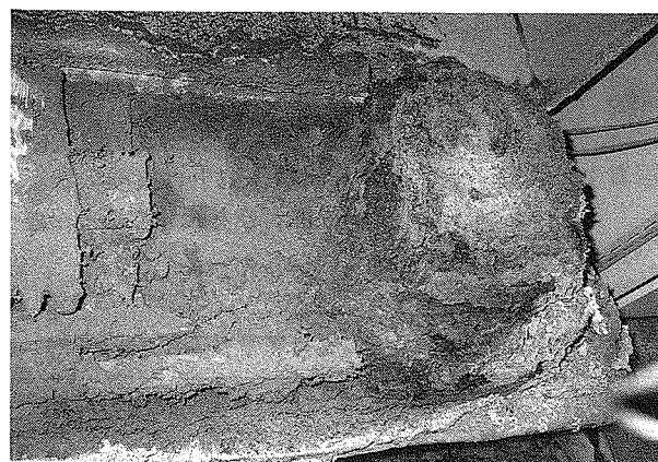
写真6 試験体設置8日後には、すべての試験体が蟻土で完全に覆われていた。
