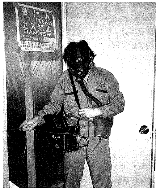
写真120 密閉燻蒸においてガス検知機でガス漏れを調べているところ
