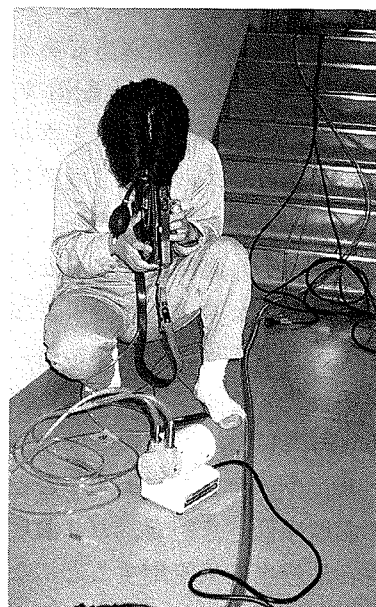
写真113 理研干渉計型ガス検定器 (18型) でガス濃度を測定しているところ (ガス採取箇所までのチューブが長いので吸引器を使用している)
