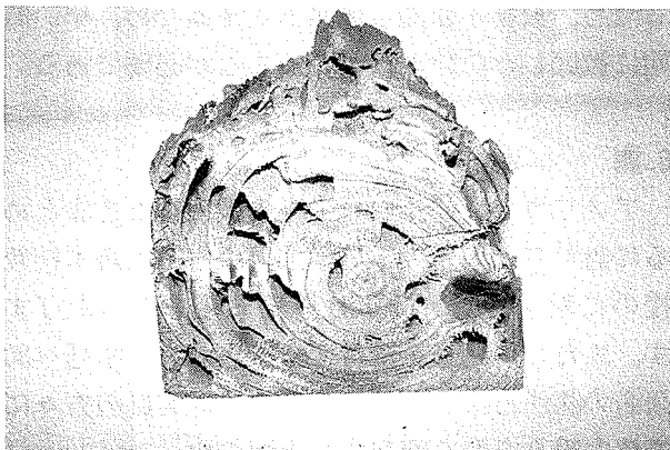
アメリカカンザイシロアリによる杉材の被害
