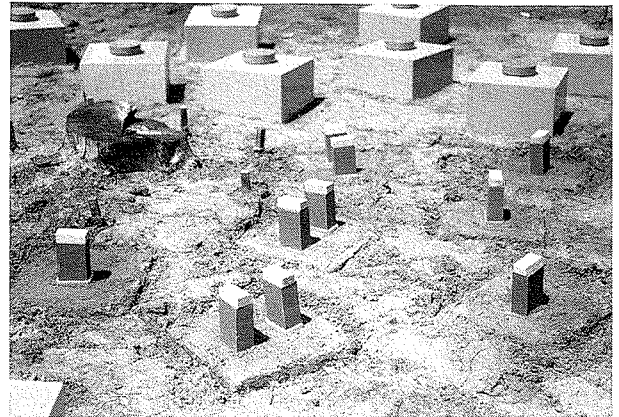
写真4 供試体の配置状況(ケースを除去したところ，左上方の切株にイエシロアリの巣がある)
