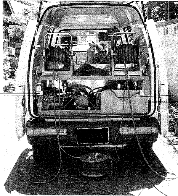
写真3 シロアリ防除作業車
