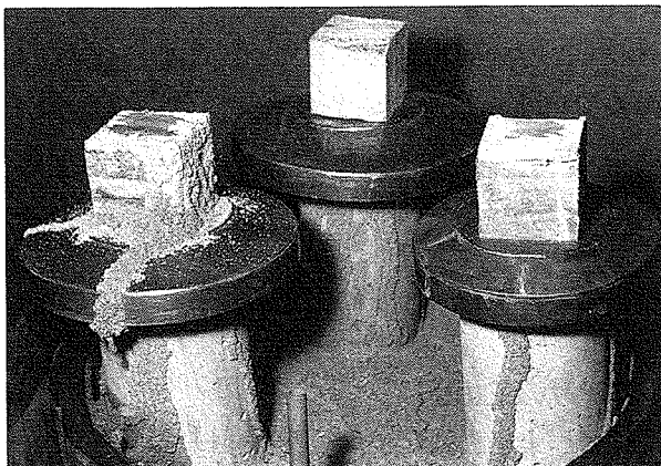
写真7 鳥栖白蟻実験所のシロアリ飼育槽上で実験中の円形防蟻板
