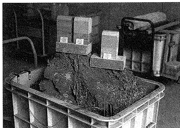
写真11 イエシロアリの巣上に設置したヒノキ防蟻効力試験の全景
