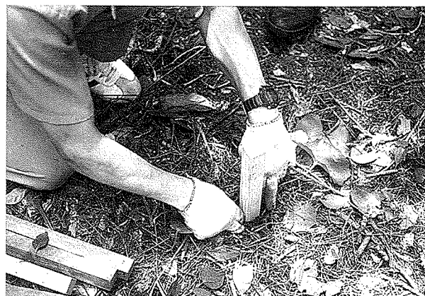
写真2 試験杭の設置
