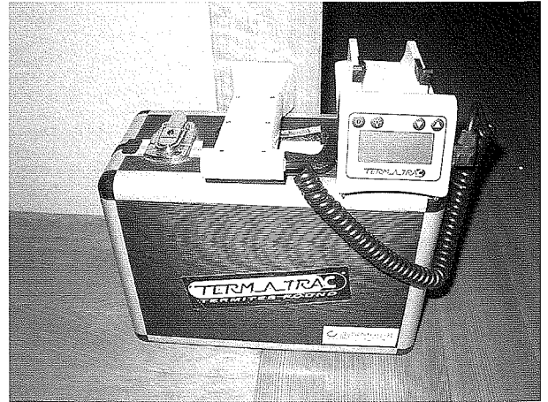
写真28 ターマトラック
