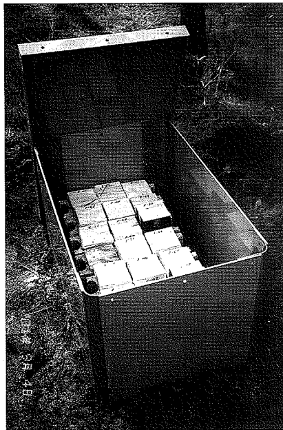
写真4 壁内・床断熱材料をセットしたコンクリートブロックを収めた底なしPVC箱
