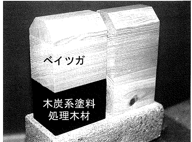
写真6 木炭系塗料処理木材設置状況
