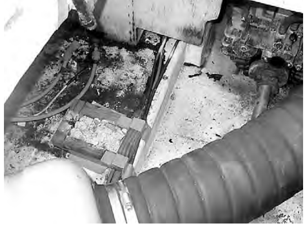
写真11 船底ベイトボックス設置
