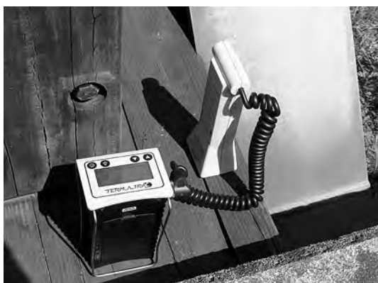
写真2 白蟻探知機を用いた生息調査
