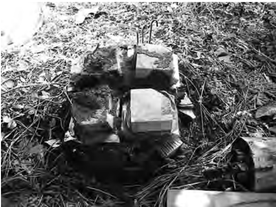
図2 種々の材質のフィルムおよび板のサンドイッチ型バリアーとしての効果の比較 左上：アクリル樹脂板 右上：ナイロンフィルム貼付アルミ板 左下：ポリエチレンフィルム 右下：ナイロン12フィルム
