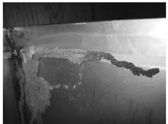
図1 水平に貼付したフィルムで蟻道が阻止されている様子
