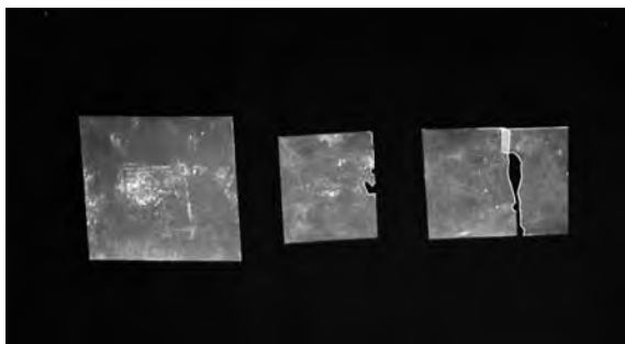
図6 フィルムはみだし幅を変えた場合および重なりを作った場合のフィルム食害状況 左：はみだし幅1cm，食害なし 中：はみだし幅5mm，端部から食害 右：中央部で重なり，重なり部から食害
