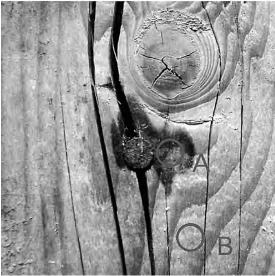
写真7 診断具を適用した実際に腐朽している木材 A：変色しており腐朽が疑われる部分 B：健全と思われる部分
