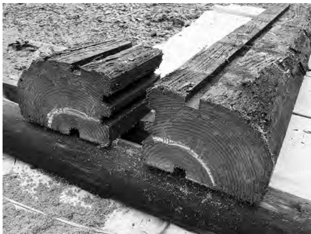
写真14 鴨居（松） 同じ切り口一対 クロタマムシ、シバンムシ複合被害。(大)
