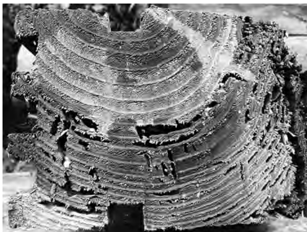
写真16 鴨居（松） クロタマムシ、シバンムシの複合被害。(大)
