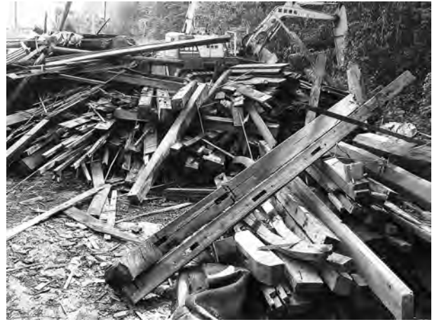
写真11 ブロッカー8 廃棄材 建物全体から出た被害材 関係。腐朽, ヤマトシロアリ, クロタマムシ, シバンムシの被害。(大)
