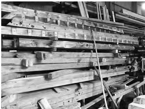
写真2 ブロッカー1 再生可能な解体材 母屋、梁、垂木関係
