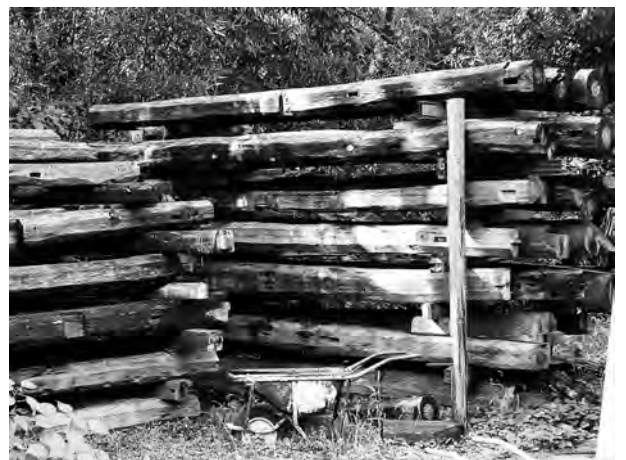
写真13 ブロッカー10 廃棄材 梁(松) 関係。シバンムシ, ヤマトシロアリ, クロタマ ムシの複合被害。(中)
