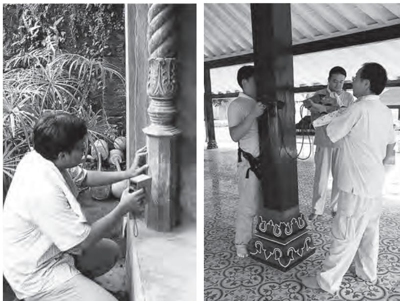
写真3 含水率の計測（左）と超音波伝搬速度の計測（右）
