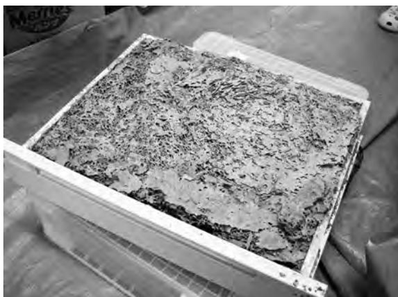
図1 琉球大でイエシロアリの被害にあった実験台（上）とその引き出し（下）実験台はほぼ半壊であり、いくつかの引き出しの中はイエシロアリの巣材で埋め尽くされていた。
