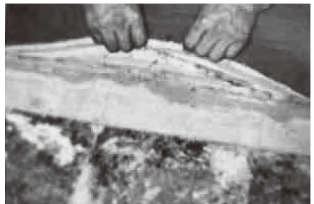
写真12 イエシロアリによるジュータンの被害
