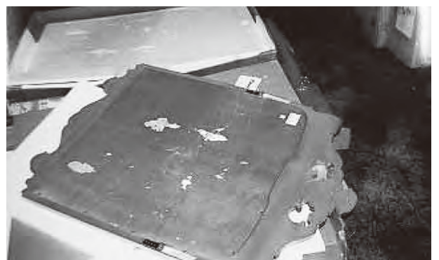
写真28 アメリカカンザイシロアリの新品家具の被害
