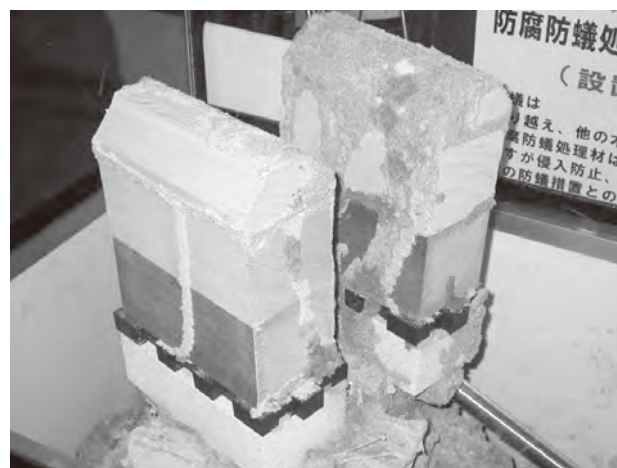
写真7 平成14年展示(ねこ土台蟻道構築)
